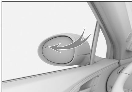
Лампы аварийной сигнализации расположены на поверхности левого и правого наружных зеркал заднего вида.
