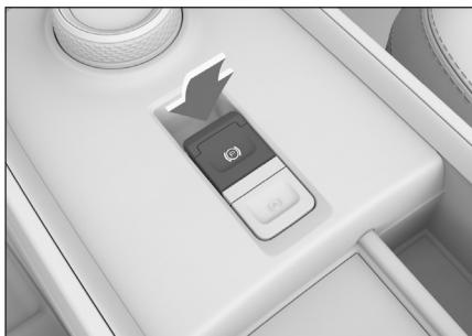
Когда выключатель питания автомобиля находится в положении ON (Вкл.), нажмите педаль тормоза и выключатель стояночного тормоза,
