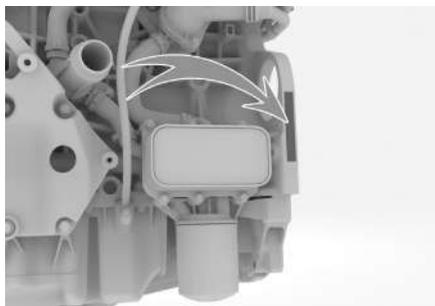
Номер двигателя выбит на блоке цилиндров, местоположение номера показано на иллюстрации.
