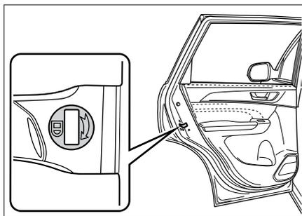
Дверь переднего пассажира и задние двери оснащены устройствами аварийной блокировки.
