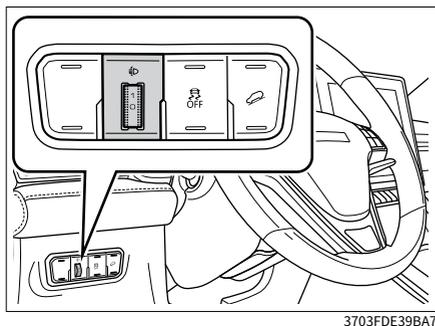
Угол наклона фар можно отрегулировать в соответствии с нагрузкой на автомобиль.
