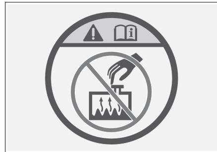
Эта наклейка расположена на крышке радиатора. Она напоминает, что нельзя открывать крышку радиатора, когда двигатель перегрет. Это создает риск выплескивания охлаждающей жидкости и получения ожогов.
