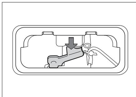
При невозможности открытия двери багажника с помощью электрической системы запираения дверей можно открыть дверь багажника изнутри автомобиля при помощи устройства аварийного открытия.
