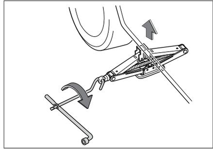
Соедините регулировочный рычаг домкрата и балонный ключ так, как показано на рисунке выше, и поворачивайте рычаг домкрата по часовой стрелке до тех пор, пока шина не оторвется от земли.
