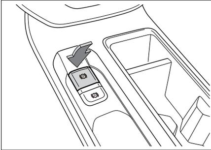
Когда выключатель зажигания находится в режиме ON, нажмите на педаль тормоза. Затем нажмите на выключатель EPB, чтобы выключить стояночный тормоз. Индикатор (Ⓒ) на приборной панели погаснет.
