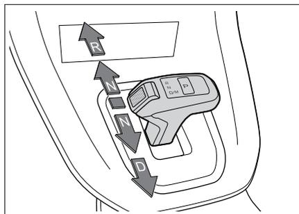
Переведите селектор переключения передач в нужное положение. После отпущения он автоматически вернется в центральное положение.
