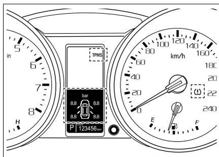
Когда система контроля давления в шинах (TPMS) выходит из строя или давление в шинах не соответствует норме, загорается индикатор неисправности системы TPMS или индикатор давления в шинах (⚠). В этом случае остановите автомобиль для проверки и свяжитесь с сервисным центром.
