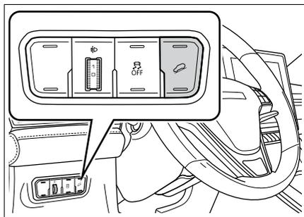
Когда выключатель зажигания находится в режиме ON, нажмите кнопку, чтобы включить или отключить систему HDC.
