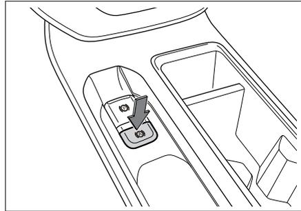
При движении на склоне, остановке перед красным сигналом светофора и движении с частыми остановками, функция автоматического удержания автомобиля (AVH, Auto Vehicle Hold) позволяет водителю не удерживать педаль тормоза длительное время и не активировать стояночный тормоз раз за разом. Она делает вождение более комфортным и снижает риск скатывания автомобиля.
