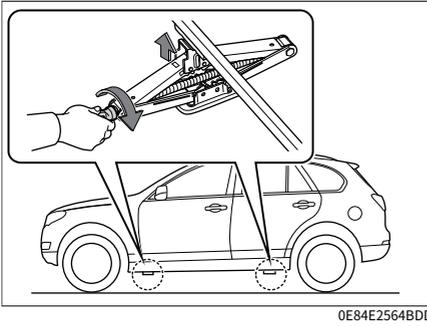
Отрегулируйте положение и высоту домкрата, чтобы обеспечить его надежную фиксацию в точке опоры.
