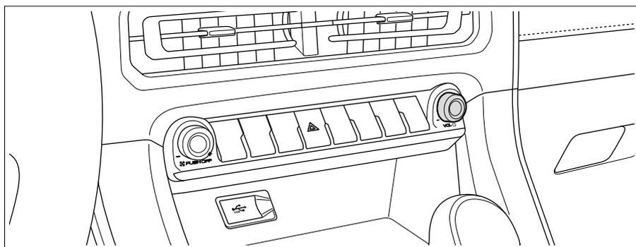
При нажатии на кнопку система переходит в беззвучный режим. При повторном нажатии на кнопку она выходит из беззвучного режима. Длительное нажатие на кнопку активирует режим ожидания; при повторном длительном нажатии на кнопку система выйдет из режима ожидания.
