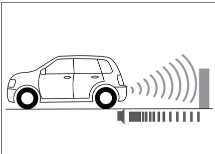
Парковочные радары представляют собой устройства радиолокационного обнаружения. Во время движения задним ходом радарные датчики обнаруживают препятствия позади автомобиля и оценивают расстояние до них. Водитель получает звуковое предупре-
