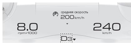
Когда выключатель зажигания находится в режиме ON, на дисплее информационного центра отображается текущая передача.
