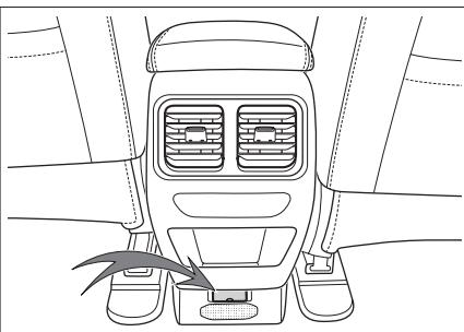
Располагается под дефлектором кондиционера в заднем ряду; для его использования достаточно открыть крышку. Предназначен для зарядки электрических устройств, таких как мобильные телефоны и планшеты.
