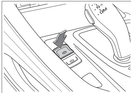
Когда выключатель зажигания находится в режиме ON, нажмите на педаль тормоза и нажмите переключатель EPB, чтобы отпустить стояночный тормоз. На приборной панели при этом загорится индикатор (P).
