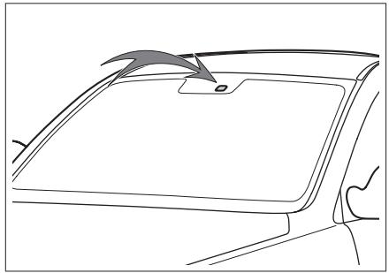
Датчик дождя и освещенности расположен в центре верхней части ветрового стекла, рядом с внутренним зеркалом заднего вида.
