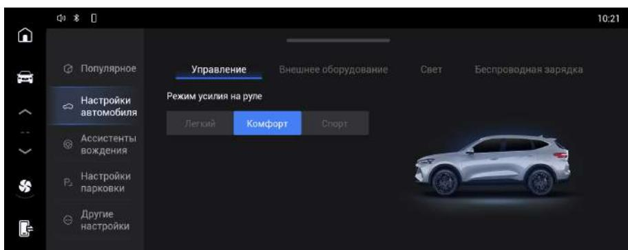
Режим усилителя рулевого управления: позволяет задать режим работы усилителя рулевого управления.
