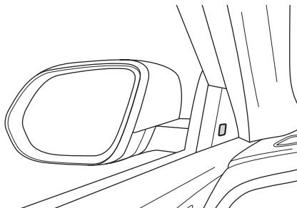
Лампы предупреждающей сигнализации расположены на рамках дверей переднего ряда с обеих сторон.
