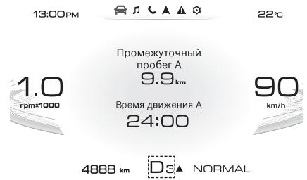
Когда выключатель зажигания находится в режиме ON, на дисплее информационного центра отображается текущая передача.
