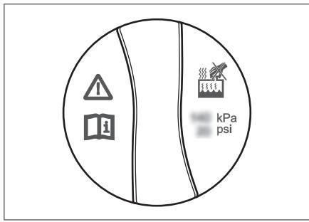
Этот знак находится на крышке расширительного бачка и напоминает о том, что запрещается открывать крышку, пока двигатель и радиатор не остыли. В противном случае может произойти выброс горячей жидкости и пара из бачка и привести к получению ожогов.
