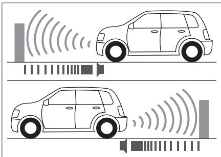
Радар предупреждения столкновений представляет собой устройство радиолокационного обнаружения. Во время парковки датчики обнаруживают препятствия спереди и позади автомобиля и оценивают расстояние до них. Водитель получает звуковое предупреждение. Благодаря этому процесс парковки становится более безопасным и комфортным.
