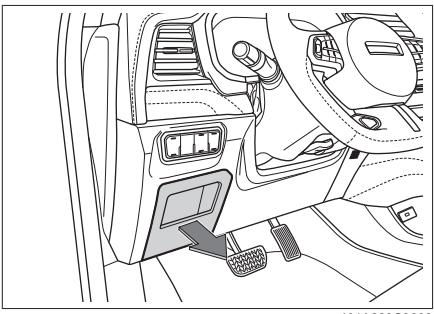
Снимите крышку блока, чтобы осмотреть предохранители.
