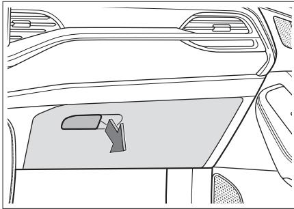
Чтобы открыть ящик, потяните ручку крышки перчаточного ящика вверх и откиньте крышку вниз.
