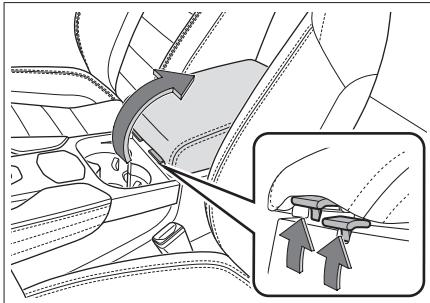
Отсек для хранения в подлокотнике переднего сиденья имеет 2 отделения. Чтобы открыть соответствующее место хранения, поднимите фиксатор и откиньте крышку вверх.
