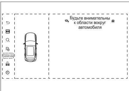
После активации функции помощи при движении задним ходом выполняйте действия согласно подсказкам на дисплее мультимедийной системы для автоматического завершения движения задним ходом.
