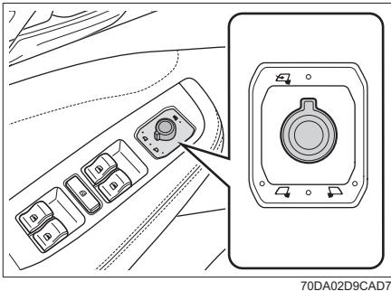
Поверните регулировочную ручку в положение , чтобы наружное зеркало заднего вида сложилось автоматически.
