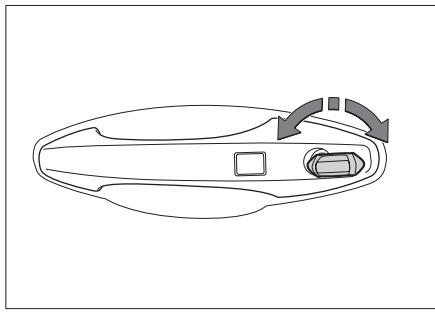
Вставьте механический ключ в замочную скважину и поверните. Таким образом можно заблокировать и разблокировать дверь автомобиля.
