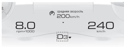
Когда выключатель зажигания находится в режиме ON, на дисплее информационного центра отображается текущая передача.
