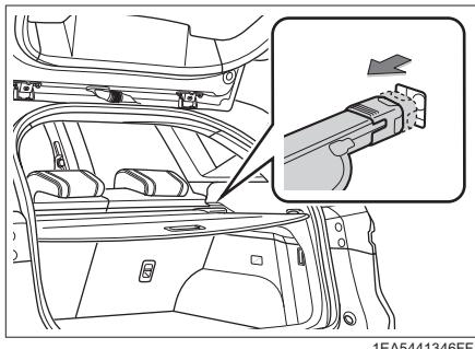
Шторку можно снять, чтобы освободить место для багажа. Нажмите на край шторки, чтобы извлечь ее из фиксатора, а затем снимите ее.
