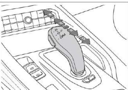
Переведите рычаг переключения передач в необходимое положение; при отпускании рычага он автоматически возвращается в центральное положение.
