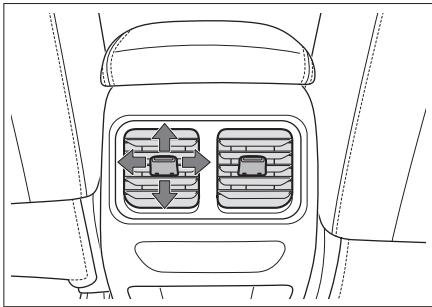
Чтобы отрегулировать направление воздушного потока, сдвиньте шторки в центральной части дефлектора.
