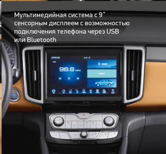
Мультимедийная система с 9" сенсорным дисплеем с возможностью подключения телефона через USB или Bluetooth
