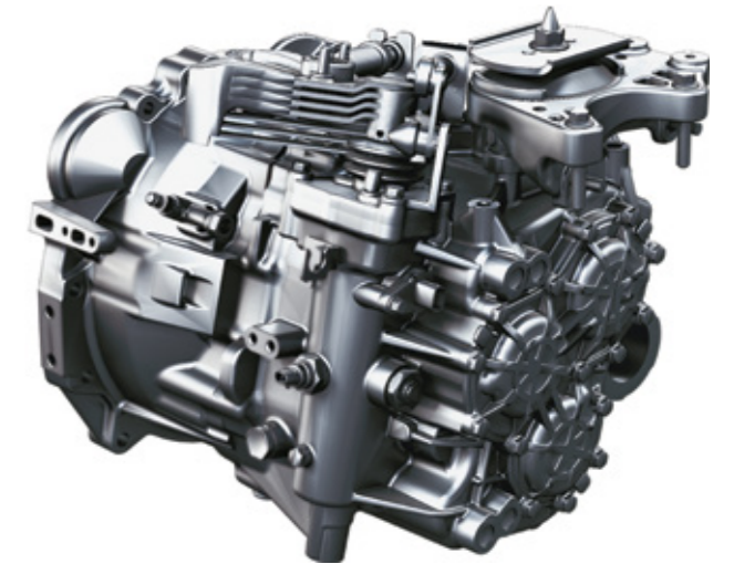
7-ступенчатая коробка передач с двойным сцеплением «мокрого» типа
